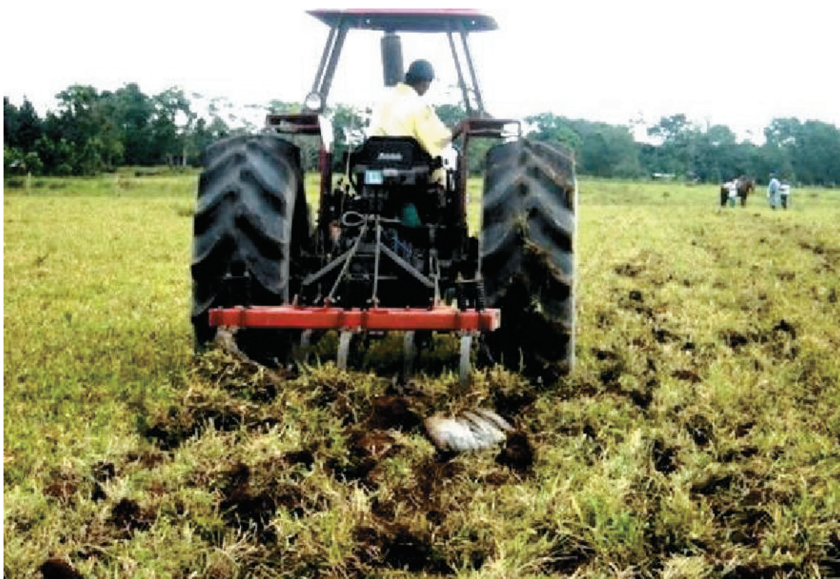
Labranza vertical con cincel vibratorio
